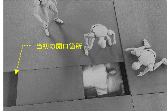
写真 5-34-5 2階床面の破壊箇所 (模型による再現)
